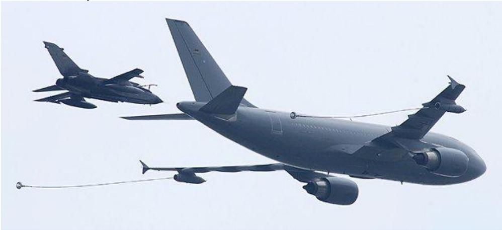
Questo tipo di aerei possono nascere già per questo scopo ed escono dalle stesse linee di produzione dei "fratelli" di linea, oppure possono diventarlo dopo un'apposita trasformazione, si modificano ex aerei di linea che magari sono vecchi per il trasporto di persone ma ancora validi per volare. Una delle ditte specializzate in queste trasformazioni è italiana.
